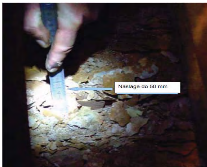
Slika 1. Naslage kamenca na gornjoj strani plamene cevi
