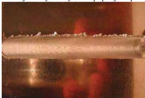
Slika 5. Spoj dve Al – ploče.
